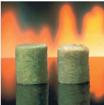
Stenull före och efter brand vid en temperatur på 750 °C (EN ISO 1182).
