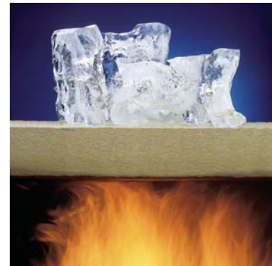
Stenull smälter inte ens vid brand. En konstruktion kan därför stå emot brand mycket längre, vilket kan förbättra räddningschansen och begränsa skador avsevärt.
